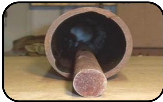
Desgaste por remoción mecánica
